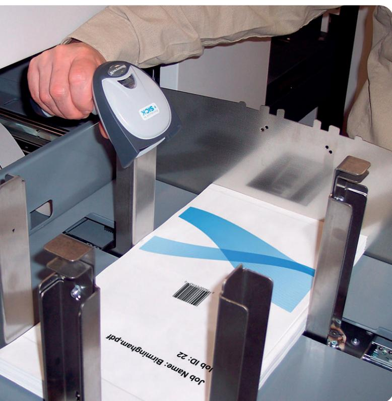
Autre atout du module d'alimentation double mode : il peut alimenter une assembleuse hors ligne. Un scanner manuel permet de lire les données JDF (Job Definition Format) présentées sous forme de code à barres sur les pages de garde imprimées de chaque projet, transférées dans les chariots d'empilage. Ce code à barres renferme toutes les informations JDF requises pour la finition.
